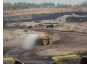
รดน้ำบนถนนภายในบ่อเหมือง เพื่อลดฝุ่นที่ เกิดขึ้นจากการจราจร
