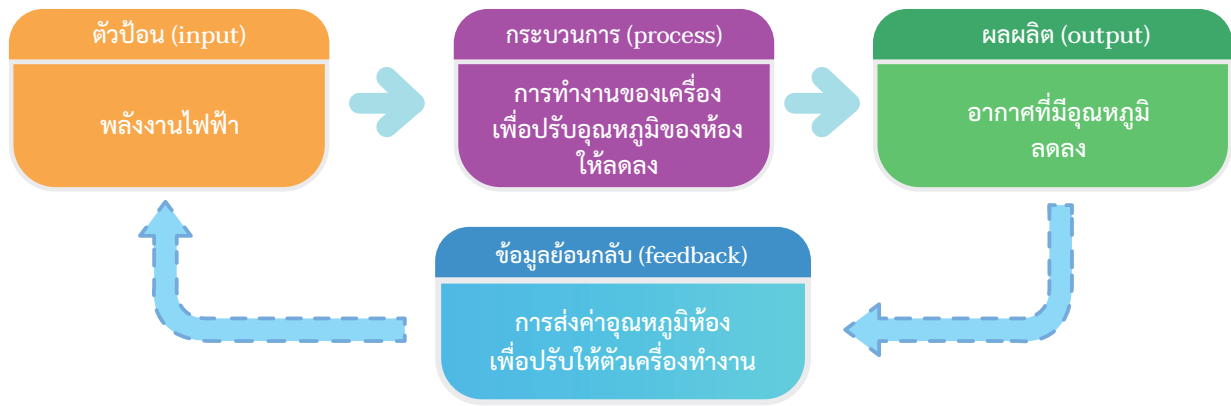
ภาพ ระบบทางเทคโนโลยีของเครื่องปรับอากาศ
