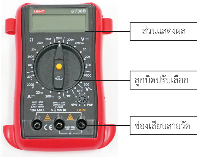
ภาพที่ 2.5 ส่วนประกอบหลักของมัลติมิเตอร์
